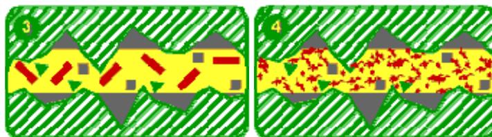
Таким образом, в местах выступов появляются первые пятна металлокерамического защитного слоя. Толщина этих пятен небольшая, так как даже при значительных энергиях слома срабатывает небольшое количество частиц ХАДО. В ходе разлома частицы размалываются вплоть до элементарных, которые уже имеют определенную структуру. Позже, в процессе домола происходит механическое удаление загрязнителей из углублений микрорельефа.
