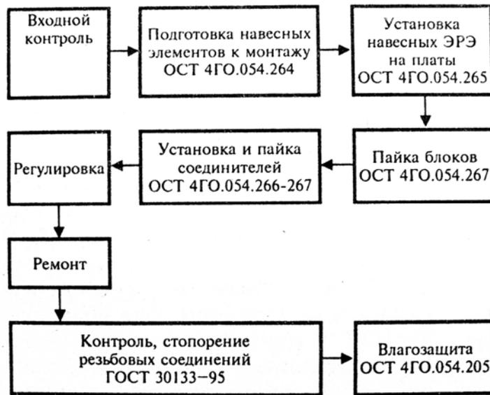
Рис. 14. Схема типового процесса сборки блоков на ПП
