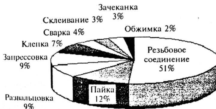
Рис. 3. Соотношение видов механических соединений
